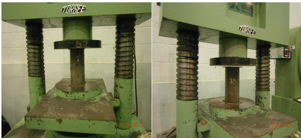
Figura 3: Ensayos de resistencia a la compresión a los 28 días.
